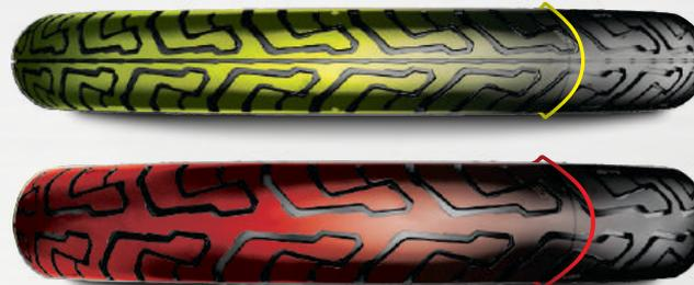
→ No pneu dianteiro, o sulco contínuo, centralizado presente na banda de rodagem têm a função de drenar a água e auxiliar na estabilidade da moto durante as trocas repentinas de direção.
